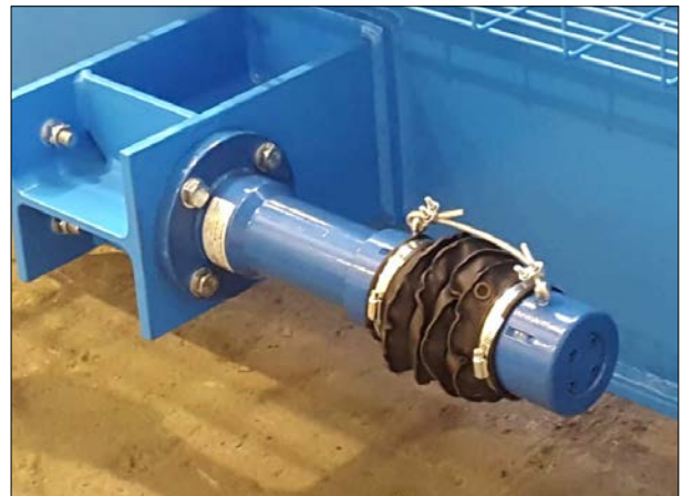
Avec options: chaîne de sécurité et soufflet de protection
